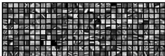
图1 由人眼关注的图像块训练得到的包含300个基向量的过完备词典,每个基向量都是192(8*8*3)维,显示成8*8的彩色图像块
